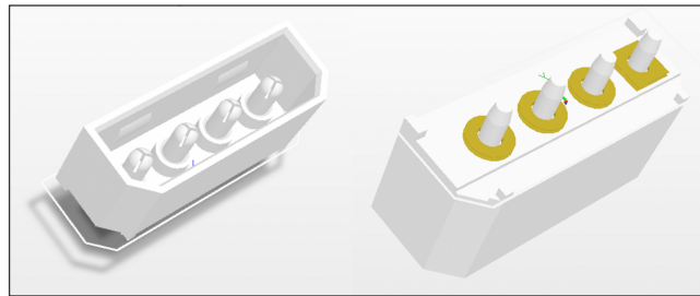
Figure 7 - Accrochage d'un modèle STEP 3D au point de référence
